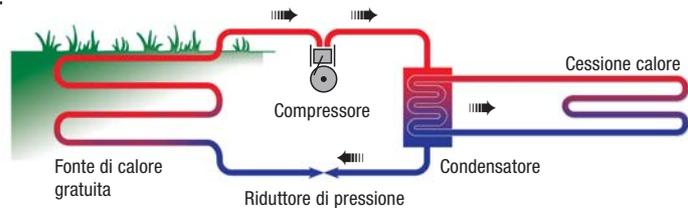
La pompa di calore **TERRA** della **IDM** usa l'energia ambientale gratuita per il riscaldamento e l'approntamento acqua calda. Lo stesso principio funziona d'estate per raffreddare ad una temperatura gradevole.
